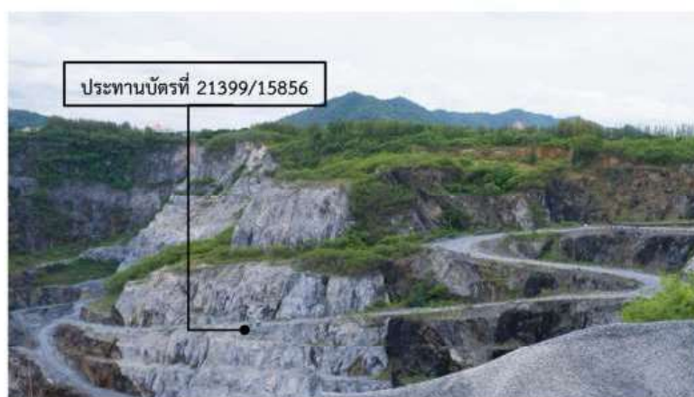
รูปที่ 1: หน้าเหมืองปัจจุบันของโครงการ และการทำเหมืองแบบขั้นบันได
